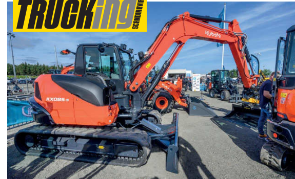
Kubota KX085-5 är en kompakt 8-tonns bandgrävare som fått ny hytt med fokus på komfort. Bland annat har luftflödet i ventilationen ökat till det dubbla.
