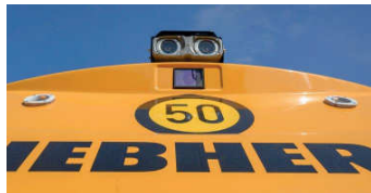
Nya kameror bak ger extra bra koll på läget runt den här Liebherr-maskinen.
