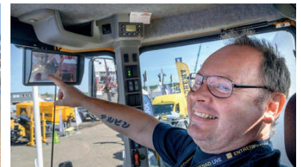
Ronny Rosenbäck, Bra Vision Scandinavia, visar displayen som visar bilderna från företagets system som ger 360 graders kameratäckning runt maskinen och har en mjukvara som varnar om det kommer in en person i området.
