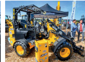
Brittiska JCB visade en midjestyrd 4,5-tonns lastmaskin som kan snabbbladdas från 20 till 85 procent på lunchen.
