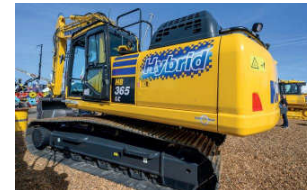
Komatsus HB365LC-3 är en 37-tonns banddriven hybridgrävare som sägs kunna minska diesel­förbrukningen med upp till 25 procent.
